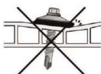
Рисунок 13с. Неправильно — не- перпендикулярное сверление
