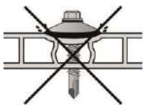
Рисунок 13а. Неправильно — избыток перенапряжения
